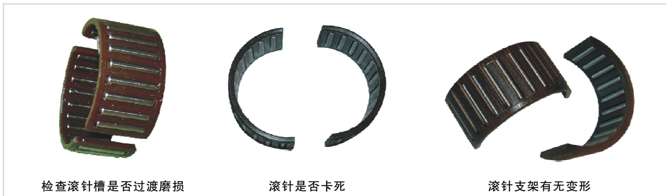
图4-42 各挡齿轮滚针轴承的检查
