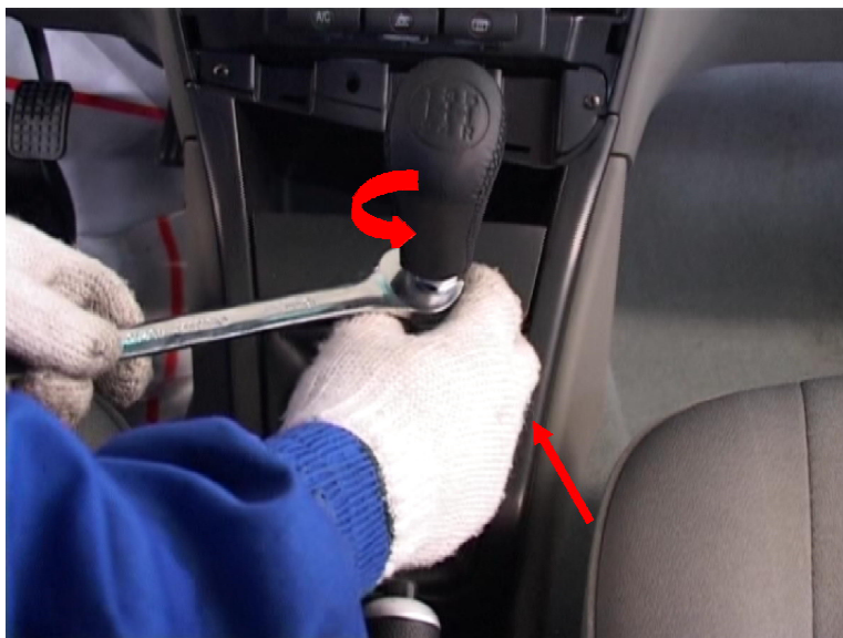
图4-71 拆下防尘罩和手柄
