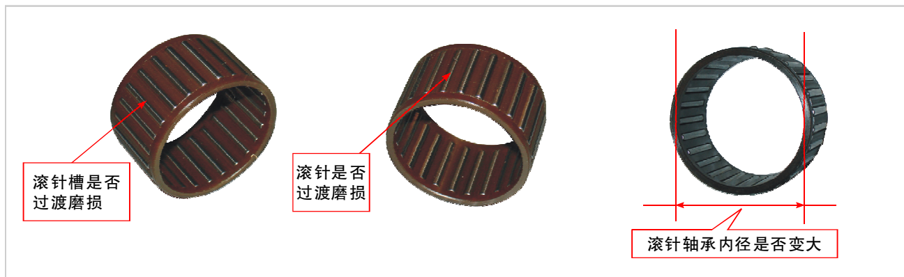
图4-48 2挡齿轮衬套检查部位
